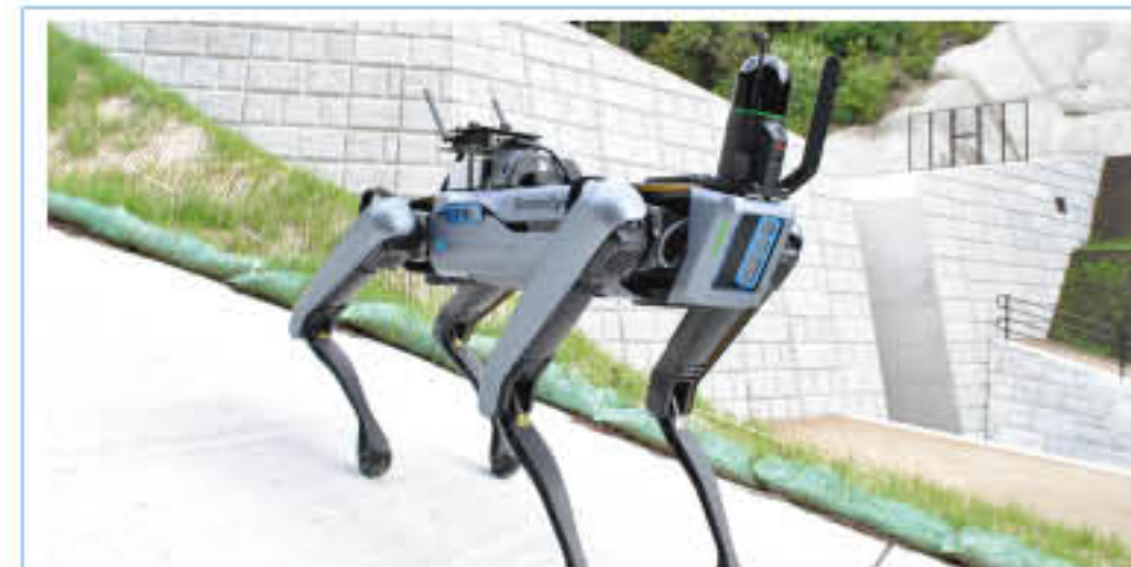
令和2年度広島西部山系原地区砂防堰外工事 自律四足歩行ロボットSpotによる3次元測量
